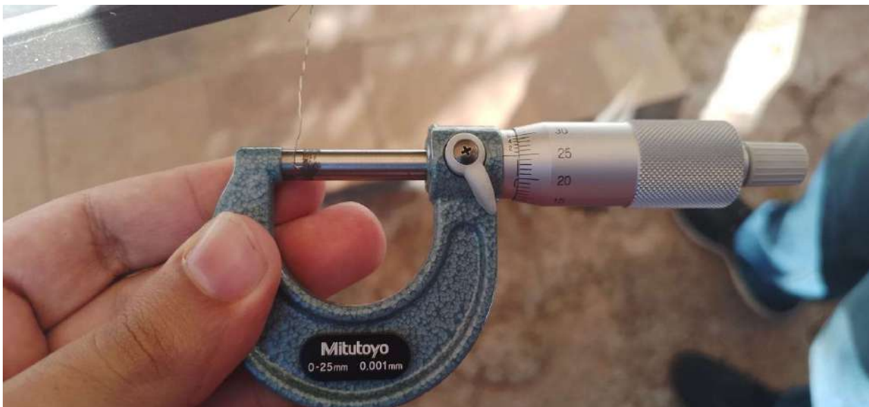
Imagem 27 – Verificação do diâmetro do fio da tela mosquiteira.
