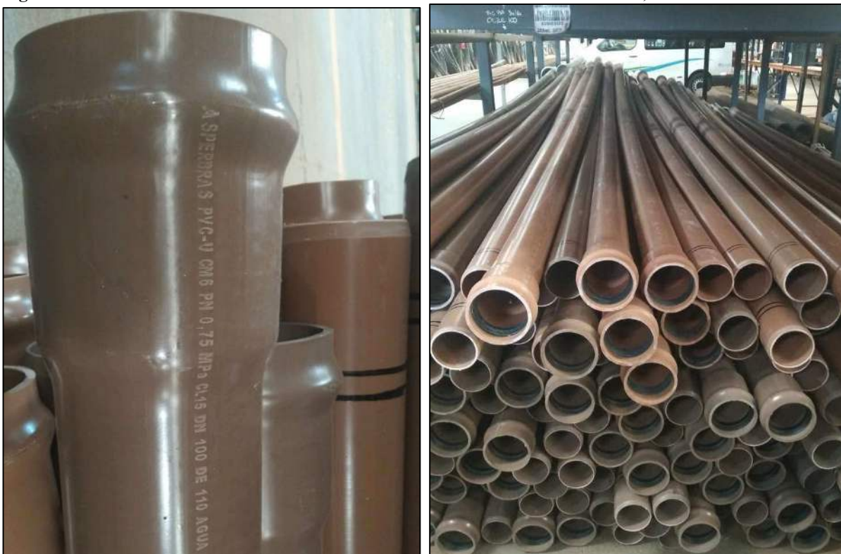
Figura 2 - Tubo de PVC/PVC JEI CL 15 DN de 100/110 mm c/anéis de borracha, conforme NBR 5647-1.
