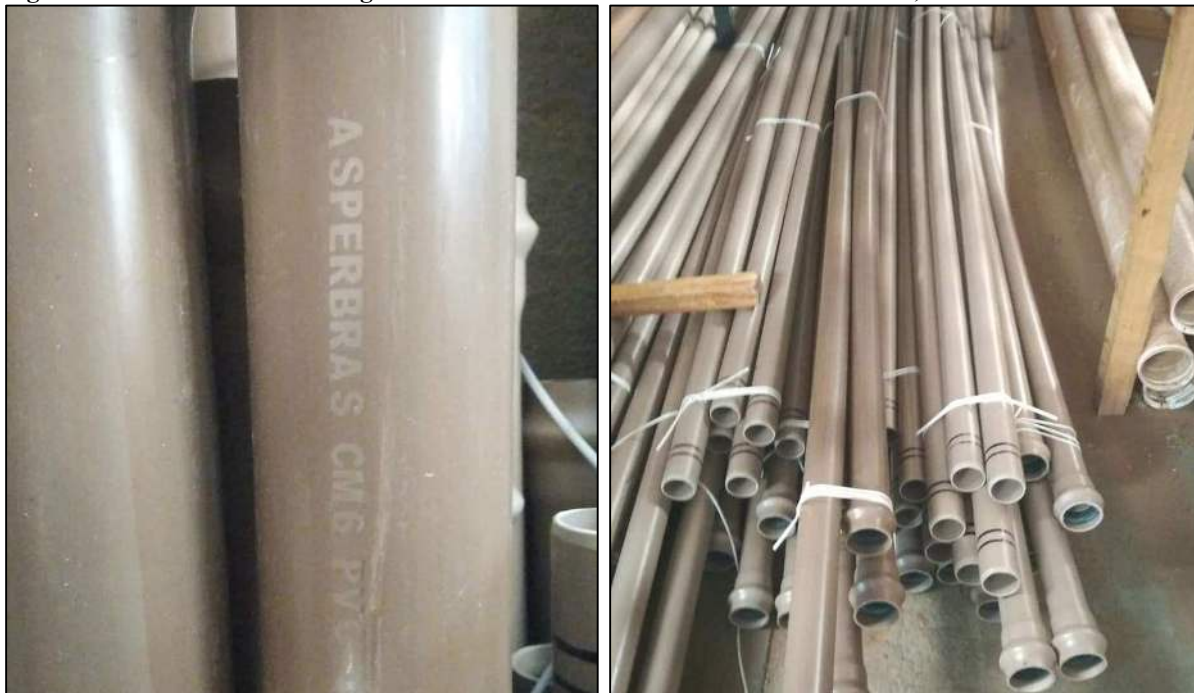
Figura 1 - Tubo de PVC/PBA rígido JEI CL 15 de 50/60 mm c/anéis de borracha, conforme NBR 5647-1.
